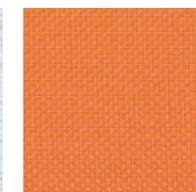
Das orangefarbene Material fluoresziert am Tag und in der Dämmerung.
